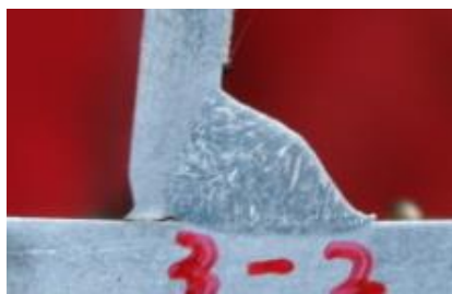
图 30-11 发生的咬边示意图
