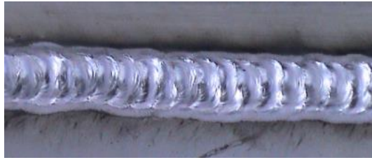
图 30-7 典型的不良焊缝例子
