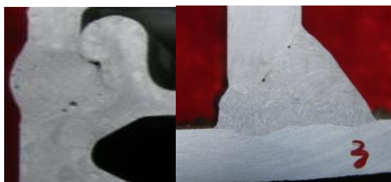
图 30-22 气孔和未熔合
