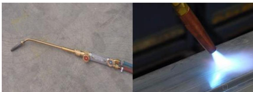
图 6-2 焊炬和加热方式
